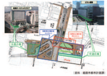
駅前広場の再整備にあわせ、隣接する宅地に2つの立体都市計画（交通広場）を決定した事例（兵庫県姫路市）
