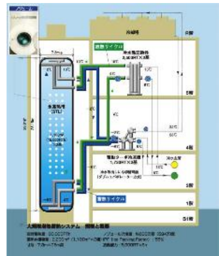
大規模潜熱蓄熱システム
